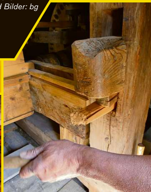
Regler aus Holz: Ein Keil bestimmt die Arbeitsgeschwindigkeit der Mühle. Wann der Mühlstein sich im richtigen Tempo dreht, entscheidet das erfahrende Ohr des Müllers.
