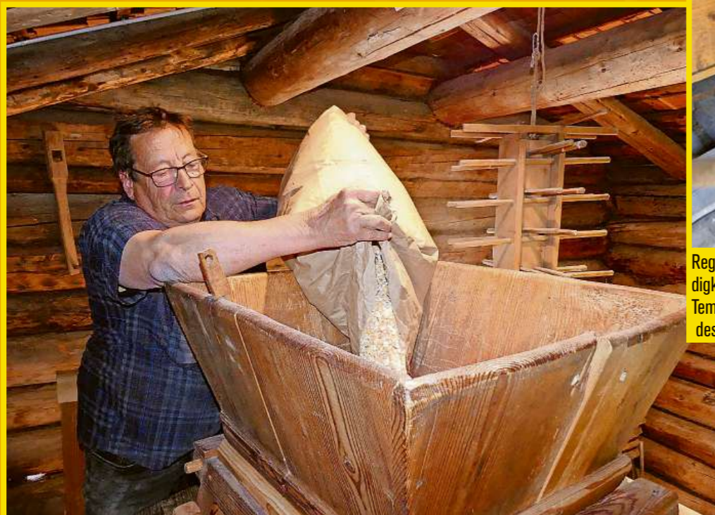
25 Kilogramm Mais leert Müller Hitsch Demont in den Trichter. Ein zweiter Sack folgt sogleich.
